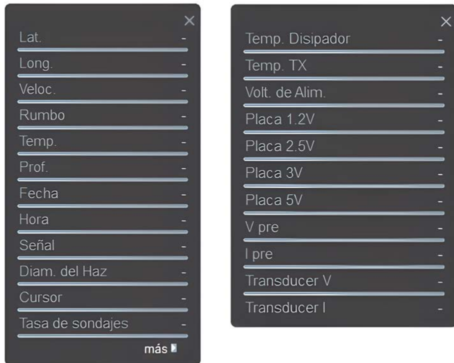
Figura 62: Ventana de visualización instantánea de datos de sondaje correspondiente a la posición actual del cursor
